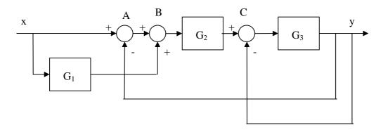
Invertiamo innanzitutto i sommatori A e B (in modo da evidenziare la connessione parallelo) e riportiamo a monte del blocco  $G_2$  il sommatore C (per riportare all'esterno della retroazione introdotta con il sommatore A quella introdotta dal sommatore C).
