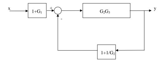
Risolviamo quindi la retroazione e moltiplichiamo per il primo blocco in serie. Otteniamo il seguente sistema equivalente
