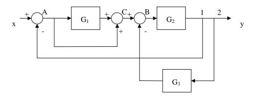
Risolviamo il parallelo e osserviamo che i punti di prelievo 1 e 2 prelevano lo stesso segnale (l'uscita del sistema). Pertanto il sistema è equivalente al seguente diagramma a blocchi.
