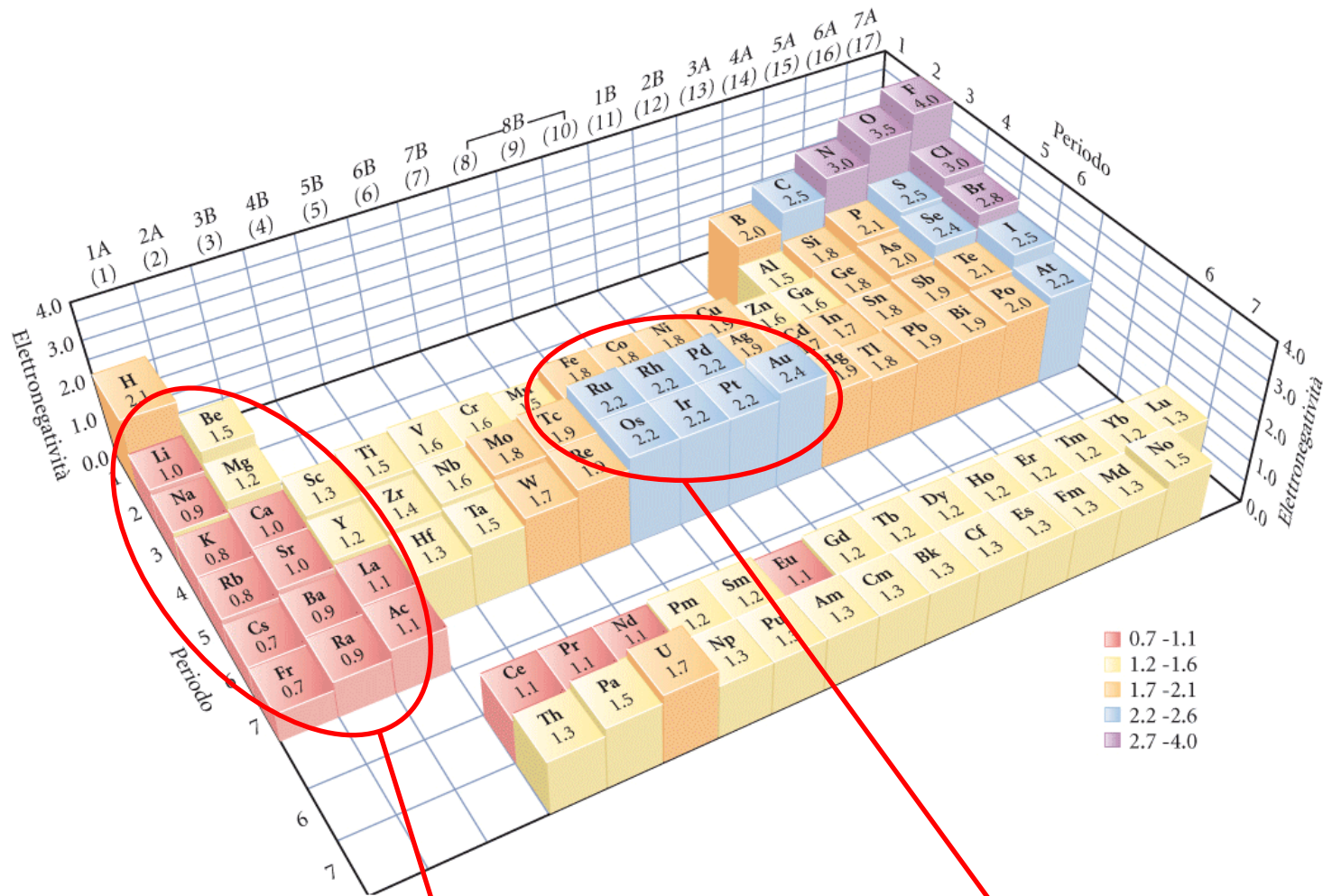
▲ FIGURA 9.8 Elettronegatività degli elementi L'elettronegatività in genere aumenta spostandosi lungo una riga nella tavola periodica e decresce spostandosi verso il basso lungo una colonna.
