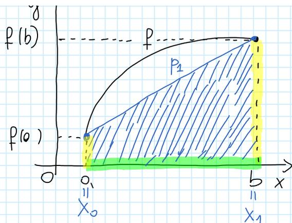
di 1° grado con nodi  $x_0 = a$ ,  $x_1 = b$ . Pertanto, geometricamente, ho
